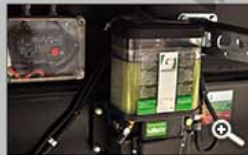
Système de graissage central de la machine
